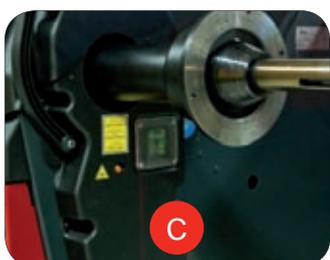
**IT** **RICERCA AUTOMATICA POSIZIONE DI EQUILIBRATURA:** Il ciclo di equilibratura viene attivato abbassando la protezione ruota. Al termine del lancio, la TECO 710 posiziona automaticamente la ruota nell'esatta posizione di applicazione del peso, sia per il fianco esterno che per quello interno.
